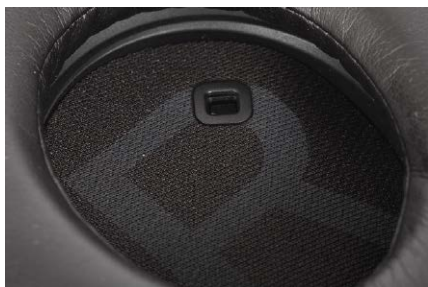
Subtelne okienko wewnątrz prawej muszli jest elementem czujników zbliżeniowych.
