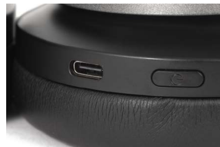
Na dolnych krawędziach muszli umieszczono tradycyjne przyciski oraz dwa gniazda – USB-C do ładowania akumulatorów oraz 2,5 mm, analogowe wejście audio.
